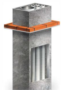
10. В надкровельной части необходимо по покрытию шахты выполнить наружную отделку из материалов для защиты от атмосферного воздействия.
