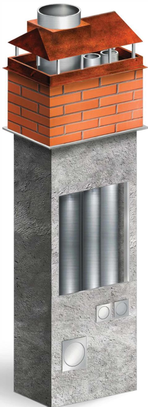
«КЛИК-ШАХТА» - вентиляционно-дымоходный блок предназначенный для устройства вентиляционных и дымоходных шахт в малоэтажных зданиях (до 3 этажей). Блок представляет собой металлический каркас с хомутами для крепления вентиляционных и сэндвич дымоходных труб (размеры труб могут варьироваться в диапазоне от 100 до 250 мм), обшитый цементно-стружечной плитой с теплоизоляционным слоем. Эффективная тепло и звукоизоляция обеспечивает комфортную эксплуатацию.
