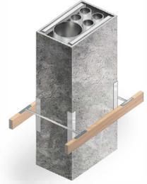
5. До пересекаемых конструкций (перекрытия, стены) соблюдать зазор 30 мм, который необходимо заполнять негорючим изоляционным материалом.
